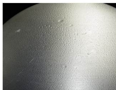
主検出器の結露状況
